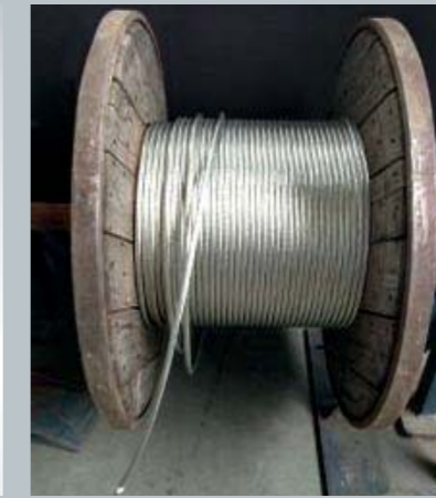
Erdungskabel Länge der Seile: individuell • Querschnitt: 70 mm 2 • Gewicht: 0,85 kg/m Merkmale: keine Isolierung, verzinkte Beschichtung
