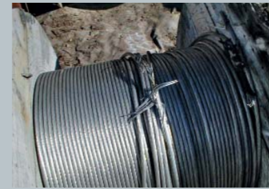
Fahrseil auf Kabeltrommel (Aluminium) 240 mm 2 , Durchmesser 20,3 mm
