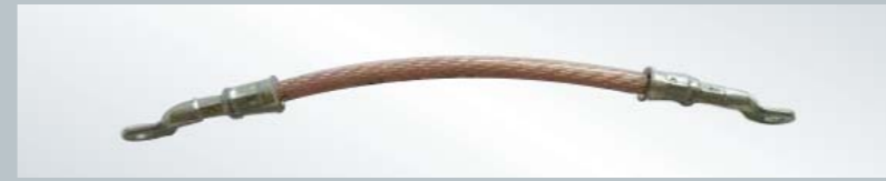
Erdungsbrücke , Länge der Brücken: zwischen 0,3 und 0,5 m • Querschnitt: 70 mm 2 • Gewicht: ca. 1 kg/m
