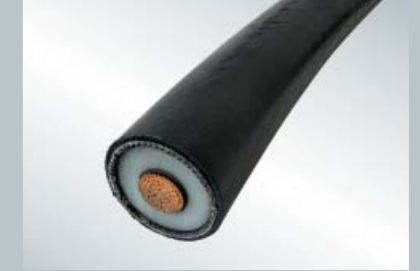
Energiekabel Kunststoffisolierung und Spannungsebene 110 kV Durchmesser: 40 und 200 mm Aufbau: mehrschichtig mit einem oder bis zu vier Leitern aus Aluminium oder Kupfer
