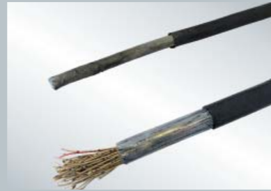
Bleimantelkabel mit papierisolierten Kupferadern, mögliche Kabeldurchmesser von 1 bis 12 cm, Kabelmantel auch ohne Kunststoffumhüllung (nur Blei) möglich
