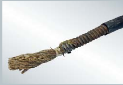
Stahlwellmantelkabel mit papierisolierten Kupferadern, verschiedene Kabeldurchmesser möglich
